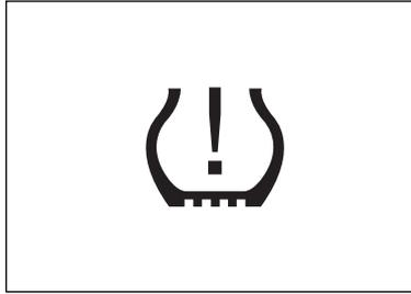
**НЕИСПРАВНОСТЬ МОНИТОРА ДАВЛЕНИЯ ВОЗДУХА В ШИНАХ**
