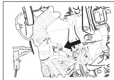
Вынесенный положительный (+) вывод расположен под красной пластмассовой крыш-кой. Для доступа к выводу сни-мите крышку.
