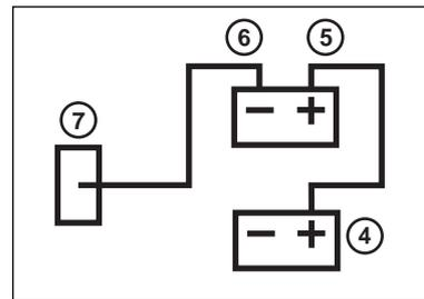
5. Следите за тем, чтобы другой конец кабеля не коснулся какой-либо металлической детали, и присоедините его к положительному (+) выводу заряженной аккумуляторной батареи.
