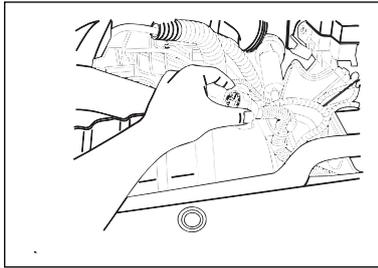
4. Затем продолжайте медленно отворачивать крышку и осторожно снимите ее.
