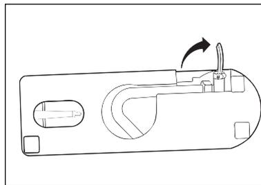
Если компрессор не имеет переключателя селектора, то потяните рычаг вверх, чтобы отсоединить воздушный шланг от емкости с герметиком.
