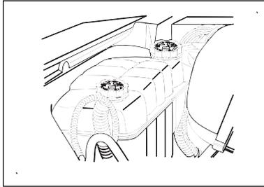
**Доливка охлаждающей жидкости в расширительный бачок системы охлаждения модуля управления силовым электродвигателем/генератором**
