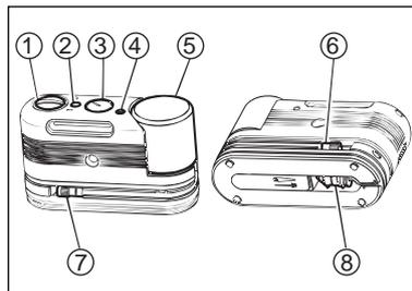
Комплект, состоящий из герметика и компрессором с кнопкой выбора подачи воздуха или герметика, включает в себя следующее оборудование:
