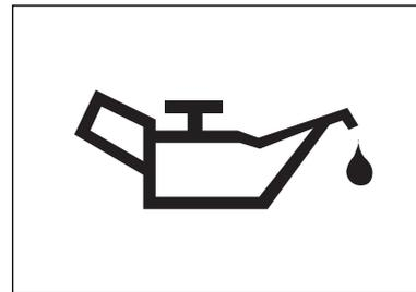
Этот сигнализатор должен загораться при включении зажигания, и продолжает гореть в течение нескольких секунд. Если сигнализатор не загорается, необходимо восстановить его работоспособность.
