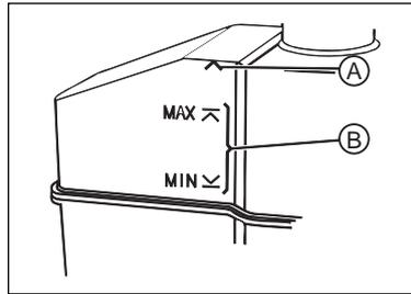
Если двигатель не работает в течение, по крайней мере, одной минуты, то уровень тормозной жидкости (A) должен находиться в верхней части бачка.
