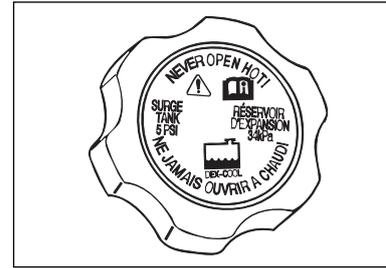
8. Установите на место пробку с предохранительным клапаном. Убедитесь в том, что крышка правильно установлена и плотно завинчена.
