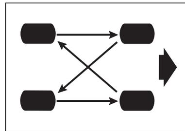
При перестановке колес следуйте приведенной выше схеме.
